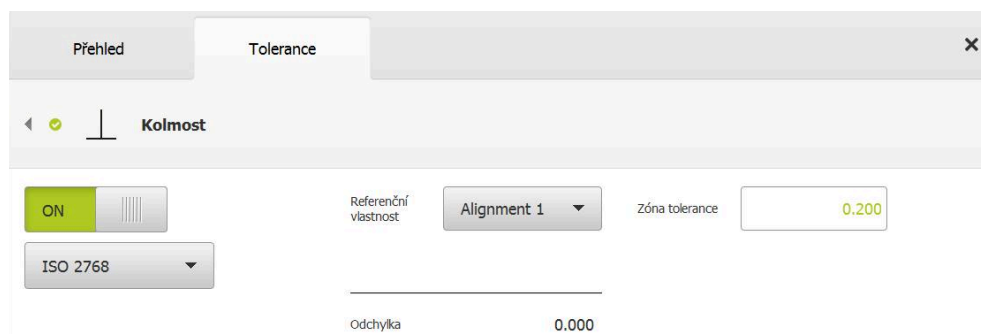
Obrázek 75: Přehled Tolerance směru s aktivovanou tolerancí Kolmost podle ISO 2768
